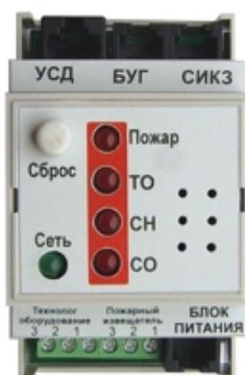
Блок коммутации и сигнализации БКС является комплектующим изделием для сигнализаторов загазованности СИКЗ и БУГ.
