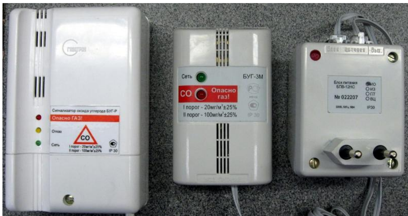
Рисунок 1 – Внешний вид сигнализаторов оксида углерода «БУГ»
